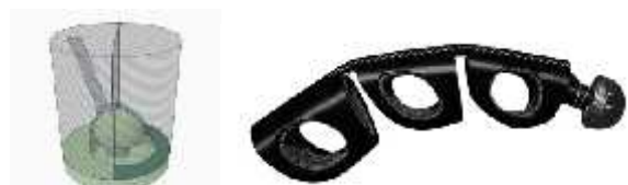
Figura 4. A la izquierda se presenta el molde utilizado para la fabricación de la punta conductiva. A la derecha el modelo de DeVo con todas las partes ensambladas.
