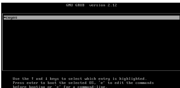
Figura 2: inicialización del sistema operativo mediante el framebuffer emulado por QEMU.
