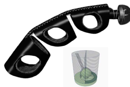
Modelo de DeVo con sus componentes ensamblados (izquierda) y molde utilizado para la fabricación de la punta conductiva (derecha).
